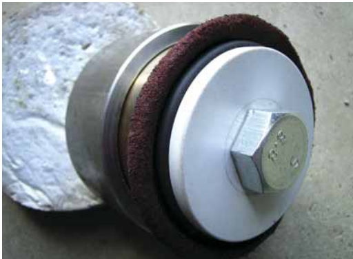
Kolben des Holzspalter-Zylinders: Bronze plus Stütz-O-Ring plus Dichtmanschette aus Lederabfällen.
