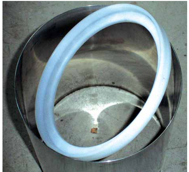
Wandung eines Zylinders inklusive PE-Dichtung für Feldbergemaschinen nach 25 Jahren Einsatz: ungeachtet des Einsatzes ungefilterten Fluß-/Bachwassers optisch spiegelnde Oberfläche.
